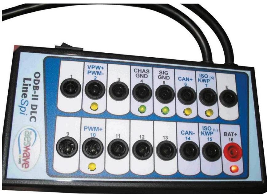
Figura 15. Esta caja de conexiones está equipada con LED que se iluminan cuando los circuitos de datos están activos.
