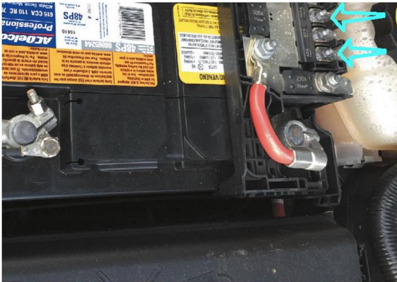
Figura 10. Puntos de distribución de energía (flechas).
