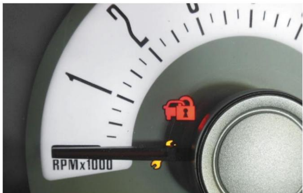
Figura 12. Una falla en el sistema de seguridad hará que la luz de advertencia parpadee y puede provocar que el vehículo no arranque.
