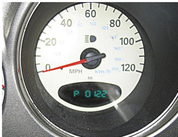
Figura 5. El DTC P0122 indica una entrada baja en el circuito del sensor/interruptor de posición del pedal/acelerador "A".
