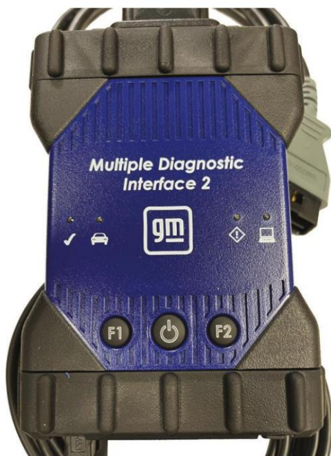
Figura 2. El GM MDI2 se conecta entre el DLC y una computadora portátil dedicada para formar la herramienta de escaneo completa.
