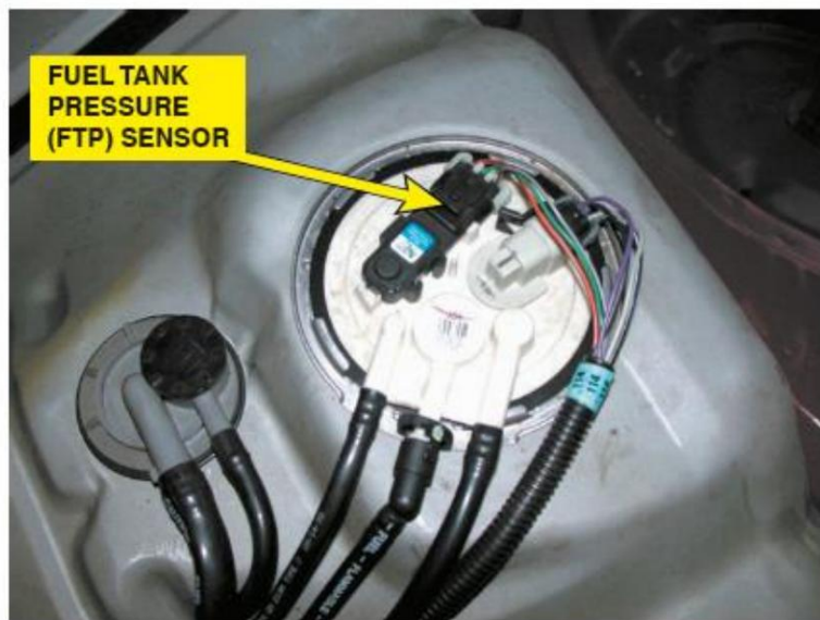
Figura 14. El sensor FTP a menudo es parte del módulo de la bomba de combustible.
