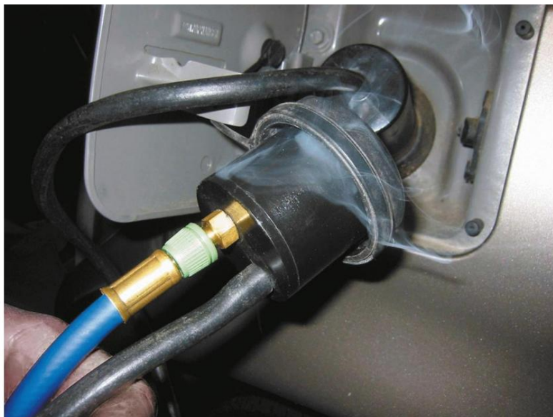
Figura 13. La prueba de humo muestra que el sello de la tapa de gasolina tiene fugas.
