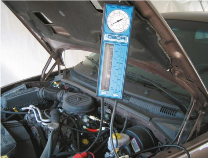
Figura 16. Un probador que mide tanto la presión como el volumen.
