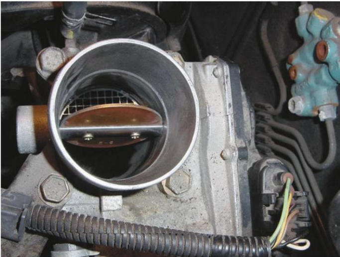
Figura 17. Limpie el cuerpo del acelerador utilizando un paño de taller humedecido con solvente.
