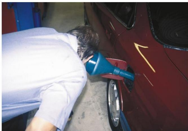
Figura 12. Escucha para confirmar el funcionamiento de la bomba.
