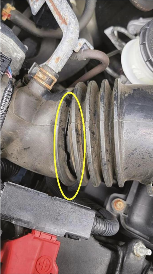
Figura 21. Inspeccione los conductos para detectar grietas y divisiones.
