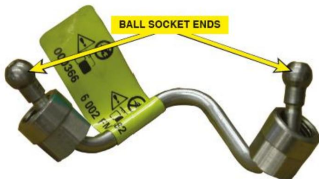
Figura 19. Una línea de alta presión GDI.
