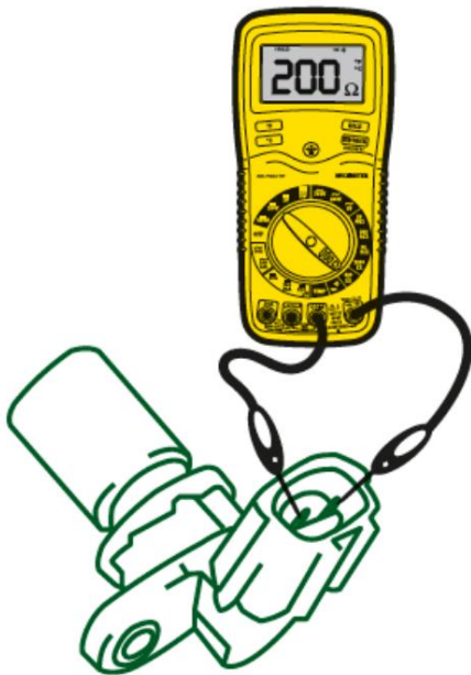
Figura 12. Comprobación de la resistencia del sensor CKP.
