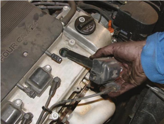
Figura 5. Verifique que la bobina COP no presente arcos eléctricos ni corrosión.
