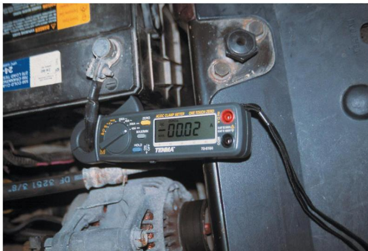
Figura 19. Un medidor de pinza inductivo puede medir el drenaje parásito.
