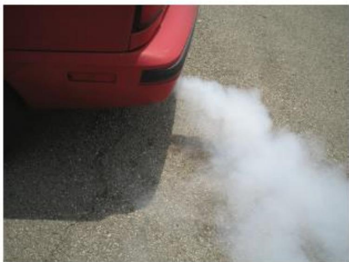
Figura 2. Un exceso de escape blanco indica agua o refrigerante en la cámara de combustión.
