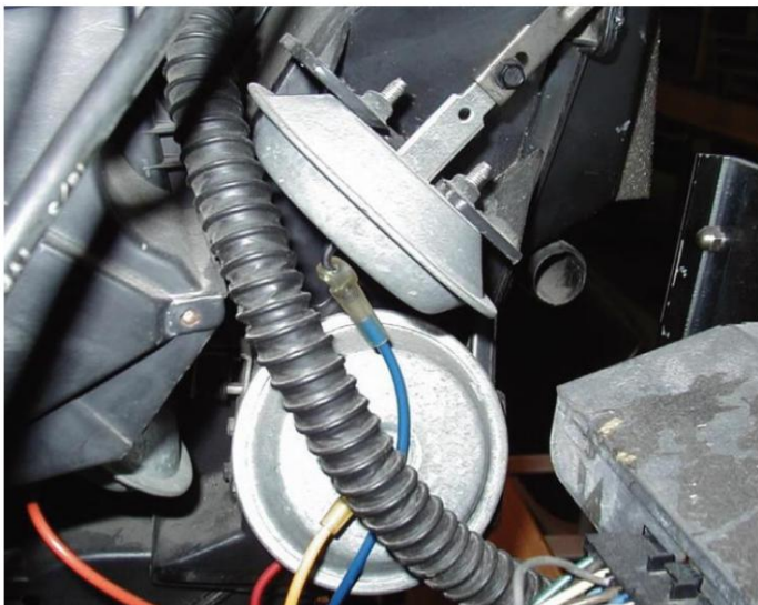
Figura 4. Muchos vehículos antiguos usaban actuadores de vacío para mover las puertas del sistema HVAC.
