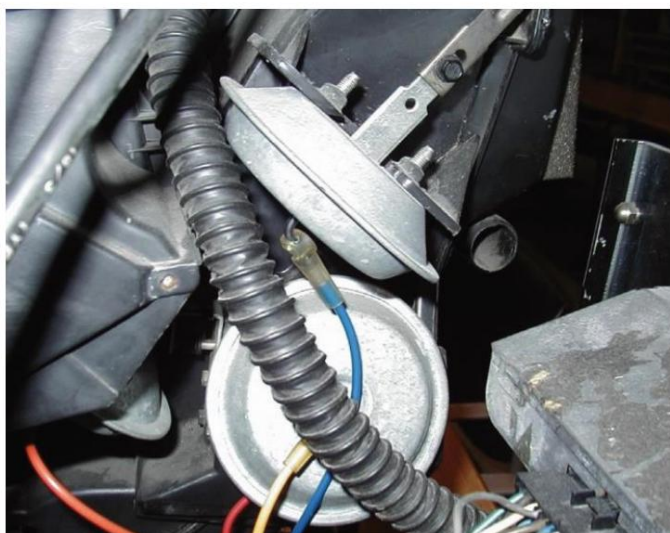
Figura 27. Motores de vacío.
