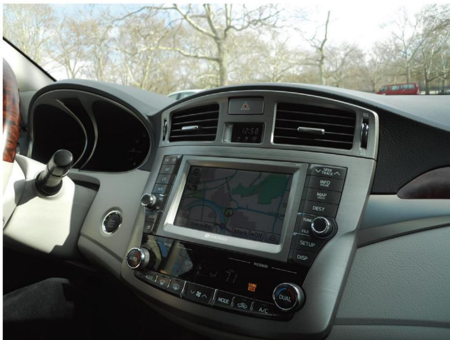
Figura 16. Un sistema de navegación con los controles HVAC debajo.
