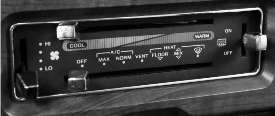
Figura 18. Controles de temperatura y modo operados por cable.
