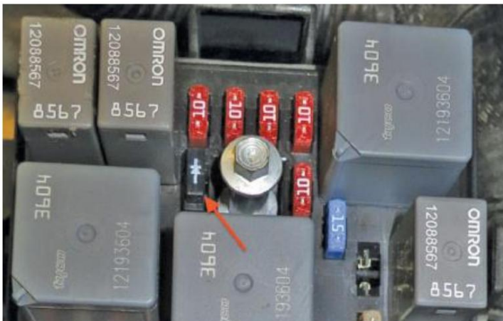
Figura 12. Diodo de supresión de picos de embrague del compresor de A/C.
