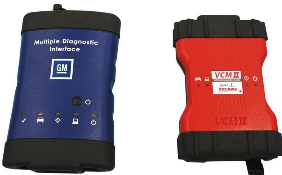
Figura 29. Herramientas necesarias para la reprogramación del módulo.
