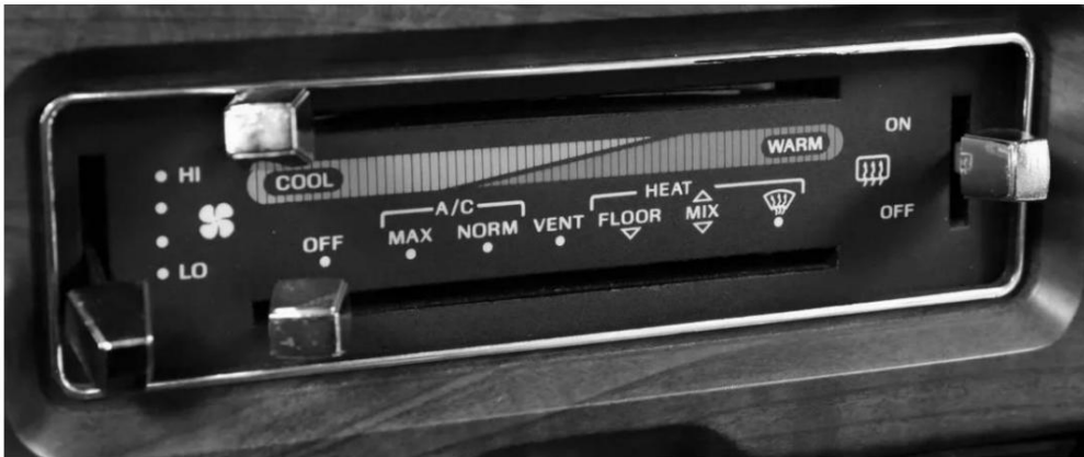
Figura 3. Sistema de aire acondicionado operado por cable. La puerta de mezcla de temperatura y la puerta de modo también se operan por cable.
