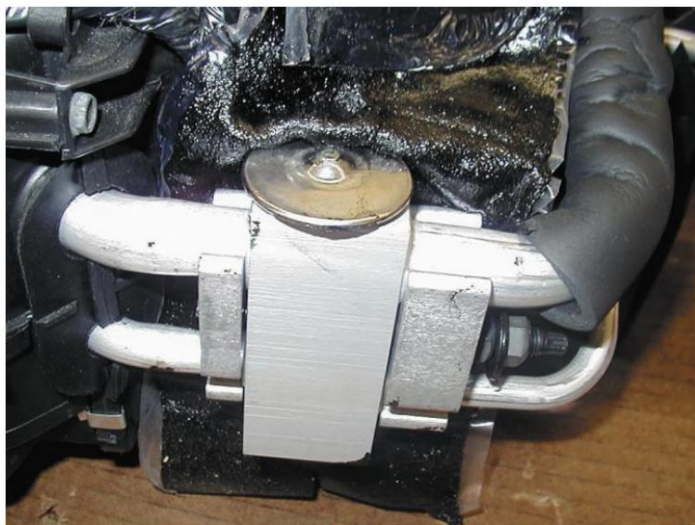
Figura 27. Una válvula H (bloque H) combina las funciones de detección de temperatura y regulación de presión en un solo conjunto.
