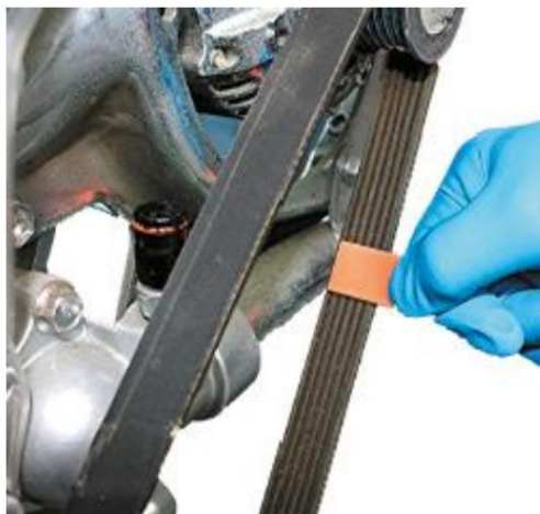
Figura 11. El medidor de desgaste de la correa debe encajar perfectamente en las ranuras. Si queda flojo, significa que la correa está desgastada y debe reemplazarse.
