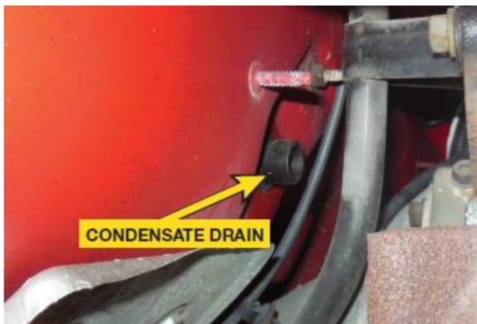
Figura 32. Verifique el drenaje de condensado para asegurarse de que esté abierto si hay agua en la alfombra del lado del pasajero.
