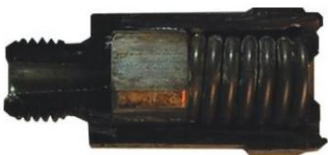
Figura 36. Una válvula de alivio de alta presión contiene un resorte fuerte que mantiene la válvula cerrada a menos que la presión del lado alto (desde la izquierda) la fuerce a abrirse.
