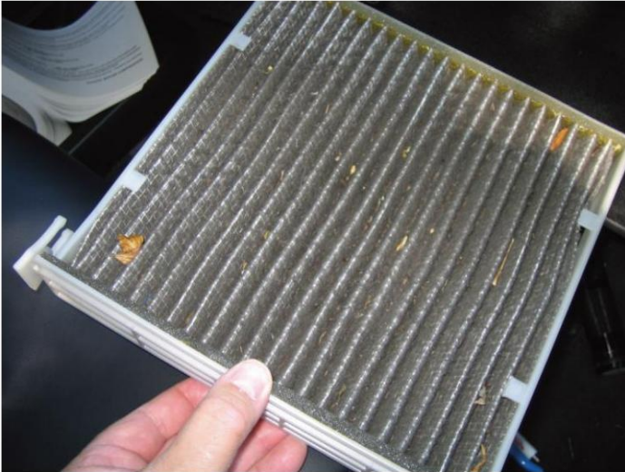
Figura 30. Un filtro de cabina sucio reducirá el flujo de aire del evaporador.
