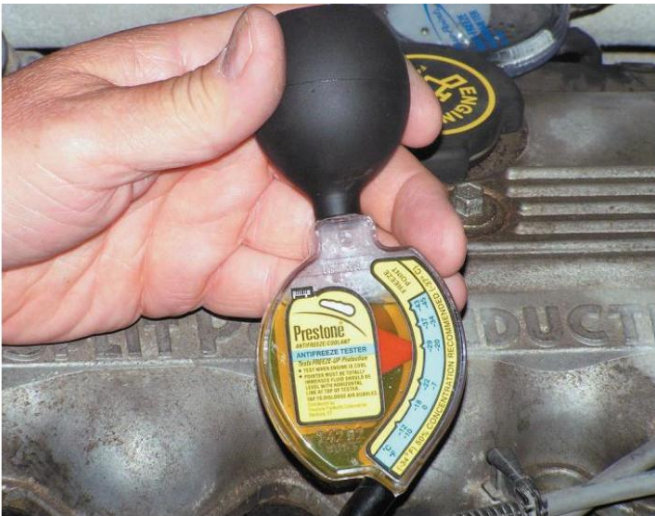
Figura 30. Comprobación de la temperatura de congelación del refrigerante mediante un hidrómetro.
