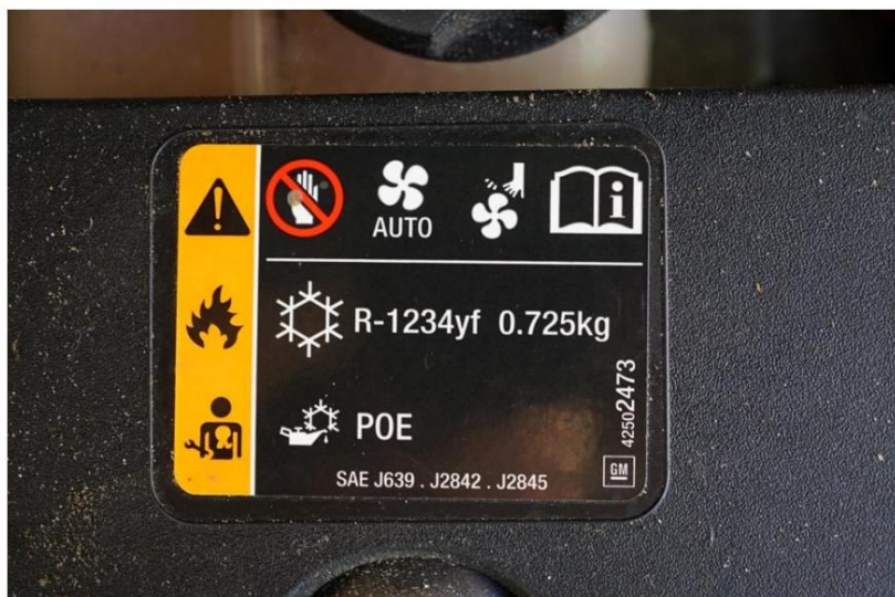
Figura 21. Este vehículo utiliza refrigerante R-1234yf y aceite POE.
