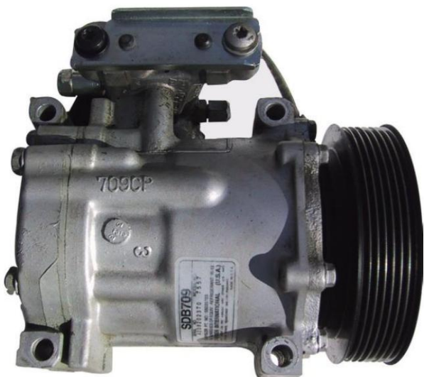
Figura 5. El compresor está montado en el motor y es accionado por una correa.
