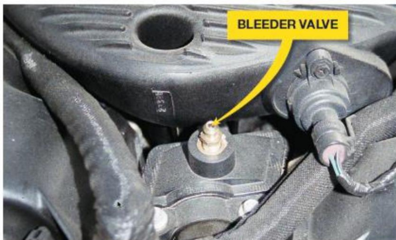
Figura 41. Abra la válvula de purga al rellenar el sistema de enfriamiento.
