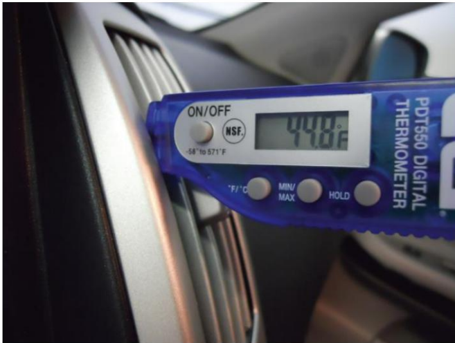
Figura 12. Mida la temperatura en las rejillas de ventilación centrales.
