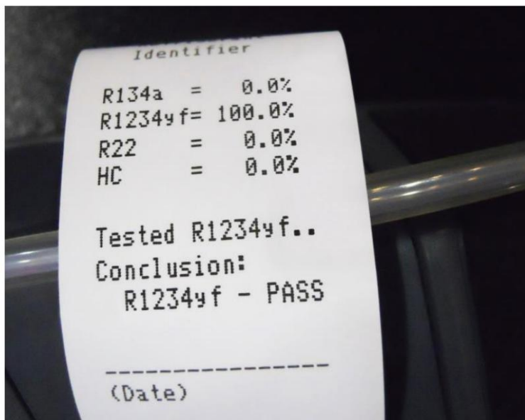
Figura 18. La impresión del identificador muestra 100% R-1234yf.
