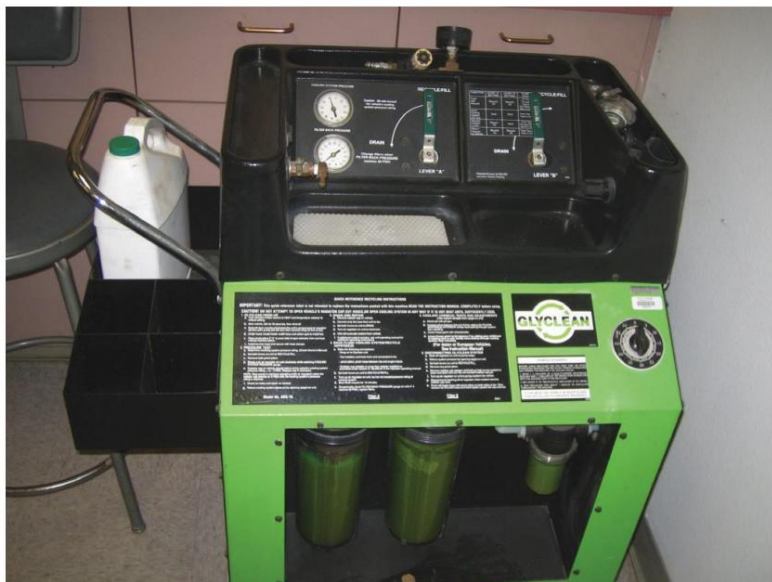
Figura 40. Una máquina de intercambio de refrigerante se encarga de limpiar y rellenar el sistema de enfriamiento.
