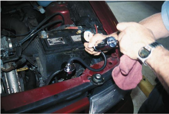
Figura 32. Prueba de presión del sistema de enfriamiento.
