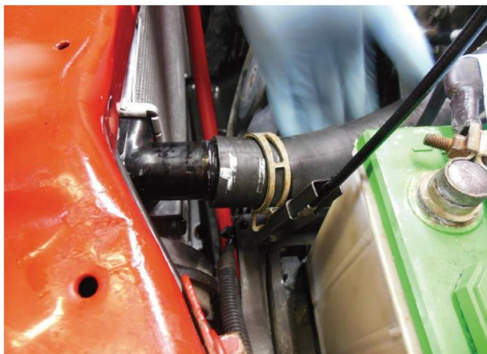
Figura 31. Utilice una herramienta de abrazadera de manguera y reemplace las mangueras según sea necesario.
