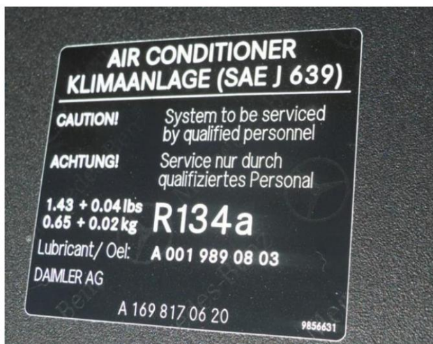
Figura 17. Este vehículo especifica refrigerante R-134a.
