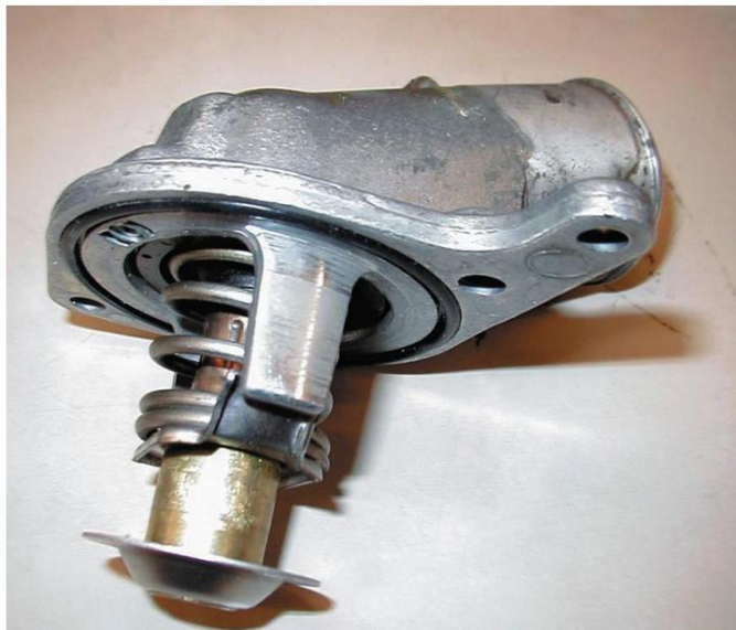
Figura 39. Este termostato se sella con una junta tórica en lugar de una junta.
