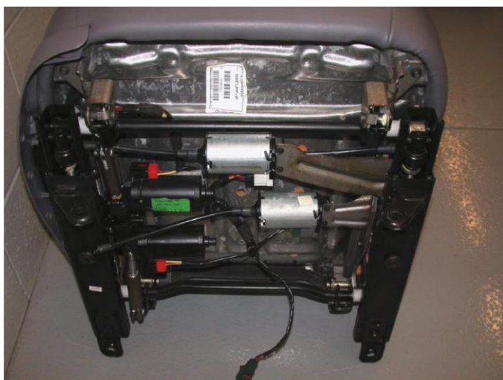
Figura 2. Un asiento eléctrico utiliza motores eléctricos debajo del asiento, que impulsan cables que se extienden para operar gatos de tornillo (arriba y abajo) o engranajes para mover el asiento hacia adelante y hacia atrás.
