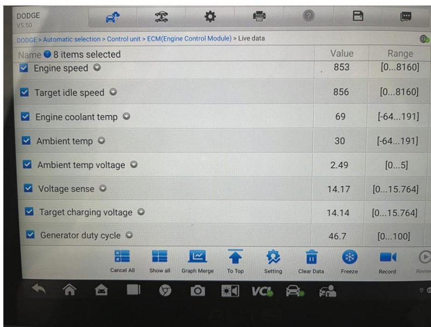
Figura 9. Una herramienta de escaneo que muestra el voltaje del alternador y el ciclo de trabajo de campo (46,7%).
