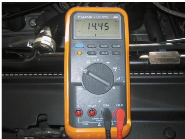
Figura 8. Prueba de voltaje del sistema de carga.
