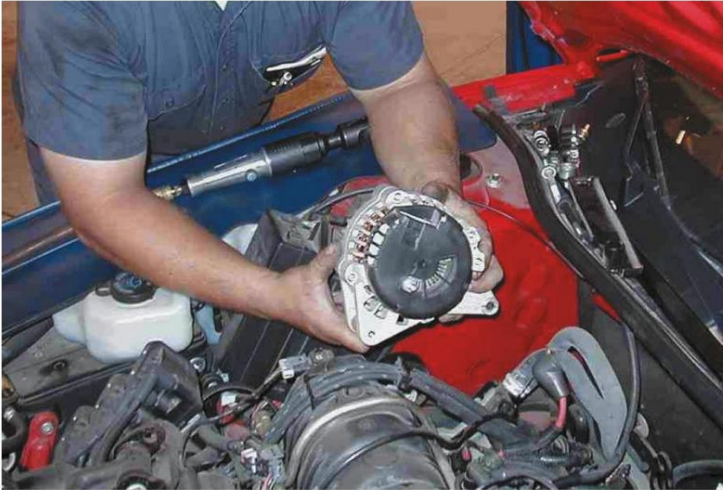
Figura 14. Extracción del alternador. Muchos alternadores son de difícil acceso y requieren la extracción de otros componentes.
