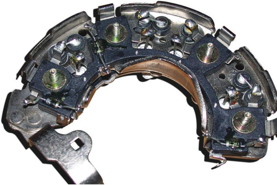
Figura 4. Un puente rectificador incluye los diodos y el dissipador de calor para refrigeración.
