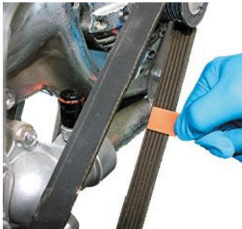
Figura 6. El medidor de desgaste de la correa debe encajar perfectamente en las ranuras. Si queda flojo, significa que la correa está desgastada y debe reemplazarse.
