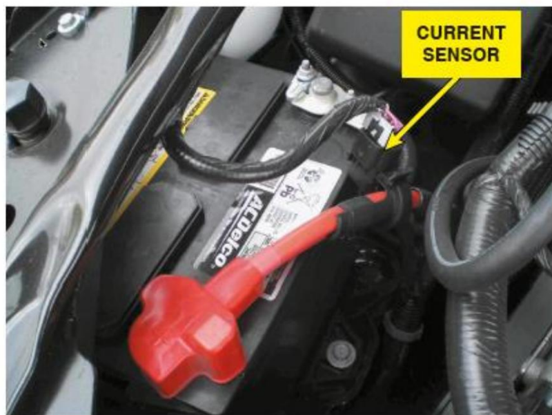
Figura 5. Se utiliza un sensor de corriente de efecto Hall conectado al cable positivo de la batería como parte del EPM sistema.
