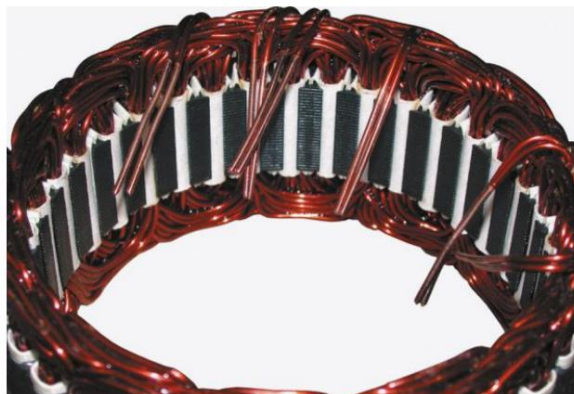
Figura 3. El estator tiene de tres a seis devanados separados.
