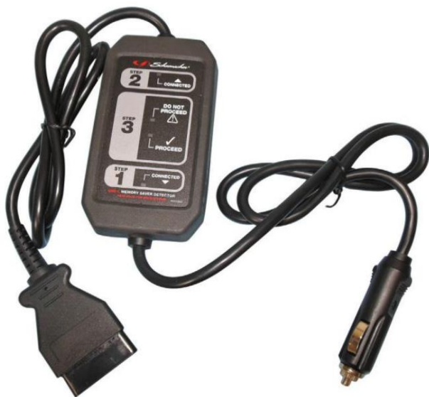
Figura 10. Este protector de memoria conecta una caja de puente a los pines 4 y 16 del DLC del vehículo.
