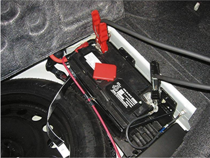
Figura 5. Una batería AGM bajo el foor, junto a la rueda de repuesto, en un vehículo híbrido-eléctrico. Un tubo de ventilación dirige los gases de la batería al exterior del vehículo.
