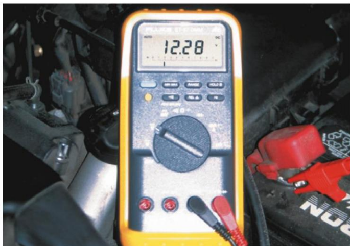
Figura 11. Medición del voltaje de la batería.
