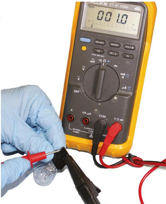
Figura 14. Uso de un multímetro digital configurado para leer ohmios ( \Omega ) para probar esta bombilla. El multímetro lee resistencia del filamento.
