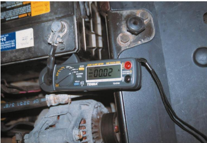
Figura 20. Se puede usar un mini multímetro digital de pinza para medir la descarga eléctrica de la batería. En este caso, una lectura de 20 miliamperios (mostrada en el multímetro como 0,02 amperios) se encuentra dentro del rango normal de 20 a 30 miliamperios.
