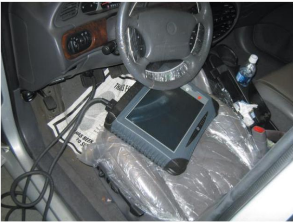
Figura 17. A menudo es necesario utilizar una herramienta de escaneo de fábrica para diagnosticar el sistema ESC.
