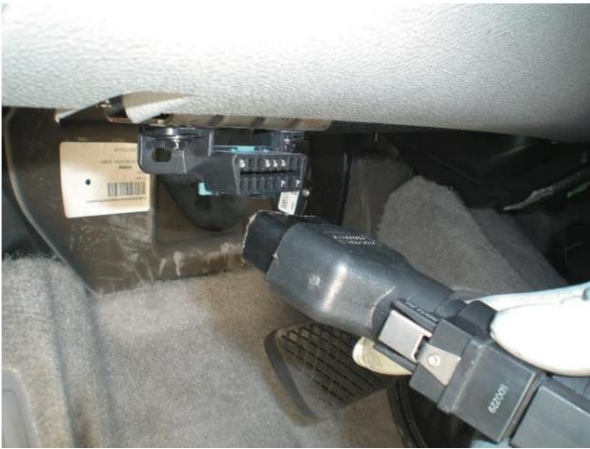
Figura 7. Conecte una herramienta de escaneo de fábrica o mejorada al conector de enlace de datos (DLC) ubicado debajo del tablero de este vehículo
