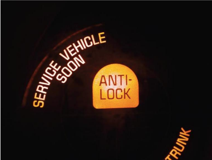
Figura 5. La luz de advertencia ámbar del ABS se enciende al arrancar y permanece encendida si hay una falla en el ABS.
