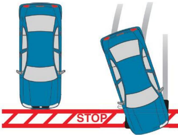
Figura 1. Poder dirigir y controlar el vehículo durante un frenado rápido es una de las principales ventajas de un sistema de frenos antibloqueo.
