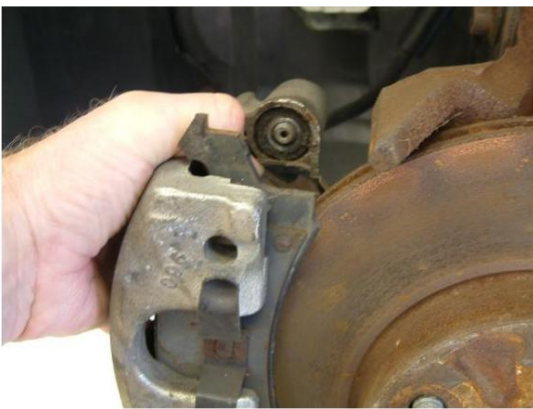
Figura 11. Deslice la pinza fuera del rotor.
