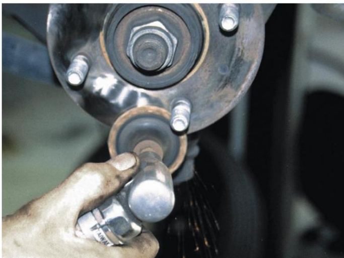
Figura 22. Limpieza de la brida del cubo.
