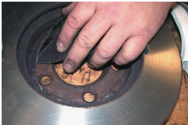
Figura 21. Limpieza del interior del rotor.
