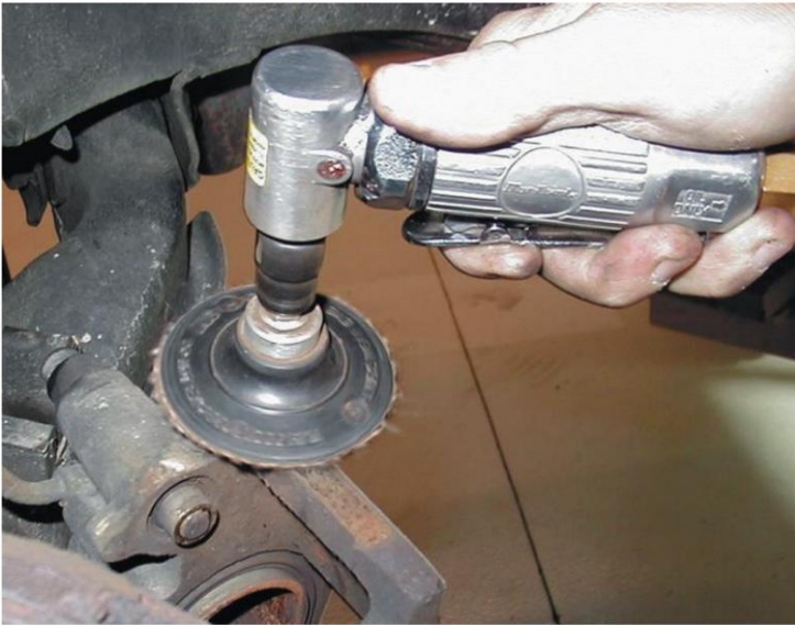
Figura 14. Limpieza de la superficie de montaje de la pinza.
