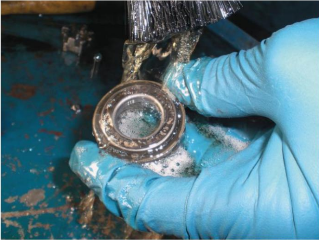
Figura 30. Limpieza del cojinete de la rueda.
