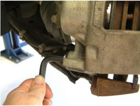
Figura 10. Afloje y retire los pernos de montaje.
