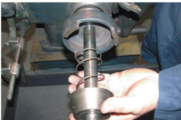
Figura 23. Utilice el cono y los adaptadores correctos para montar el rotor.
