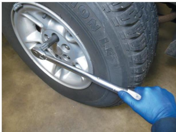
Figura 29. Una llave dinamométrica que se utiliza para apretar las tuercas de las ruedas de una camioneta.
