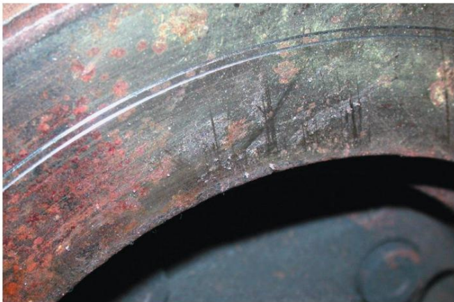
Figura 24. Los cortes de raspado están uno al lado del otro. Se puede continuar con el mecanizado.
