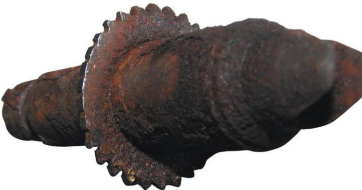
Figura 20. Una rueda de estrella ajustadora desgastada.
