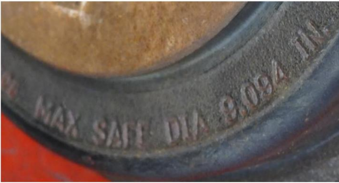
Figura 12. Este tambor se puede mecanizar hasta un diámetro máximo de 9,064 pulgadas, dejando 0,030 pulgadas para el desgaste.
