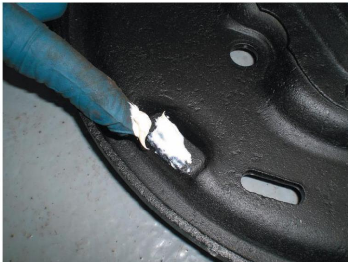
Figura 21. Lubrique la placa de respaldo.
