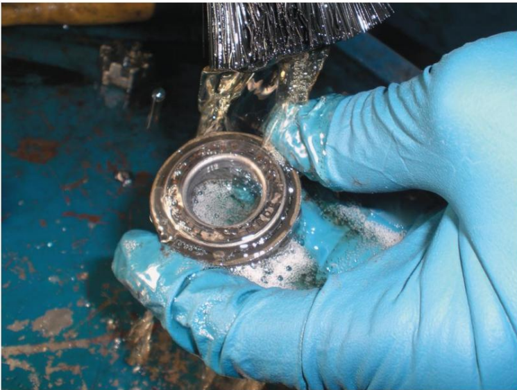
Figura 28. Limpieza del cojinete de la rueda.
