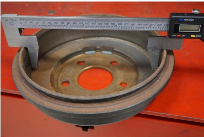
Figura 13. Se realizan mediciones precisas con un micrómetro de tambor de freno.
