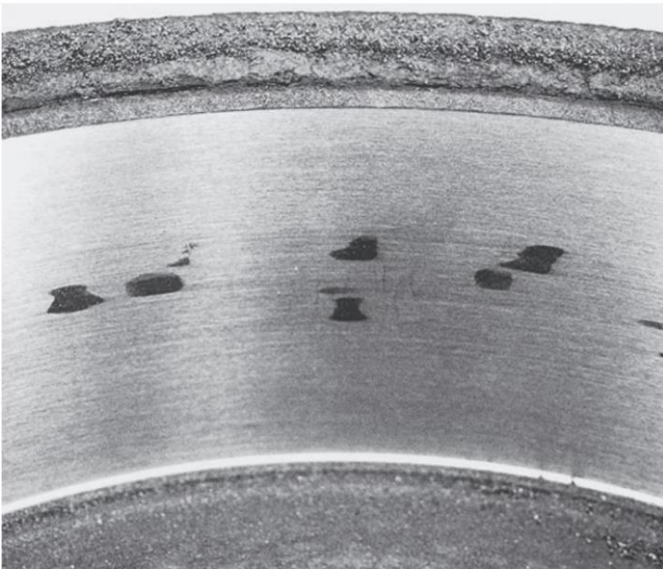
Figura 11. Los puntos duros requieren el reemplazo del tambor.
