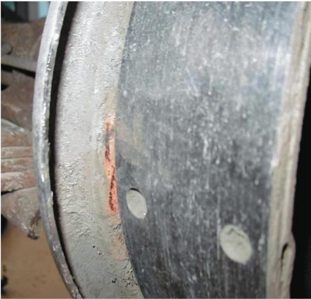
Figura 18. Placa de soporte oxidada y desgastada.
