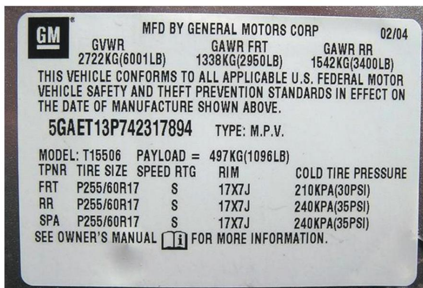
Figura 10. Etiqueta de certificación de seguridad de un vehículo típico que muestra el peso bruto del vehículo/clasificación del peso bruto de los ejes/así como el tamaño y la presión de inflado de los neumáticos.
