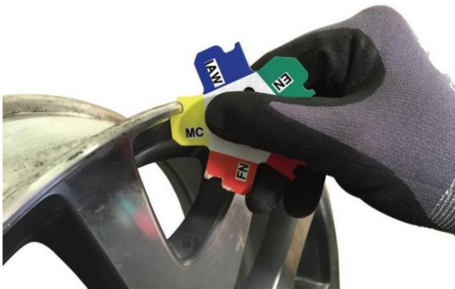
Figura 22. Se utiliza un calibre de contorno de llanta para seleccionar el tipo de peso correcto.
