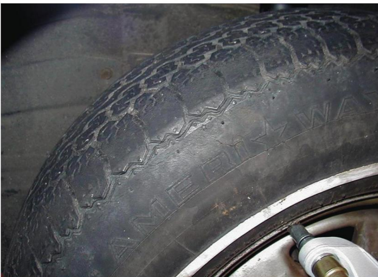
Figura 5. El desgaste solo en el hombro exterior es una indicación de un problema de alineación.
