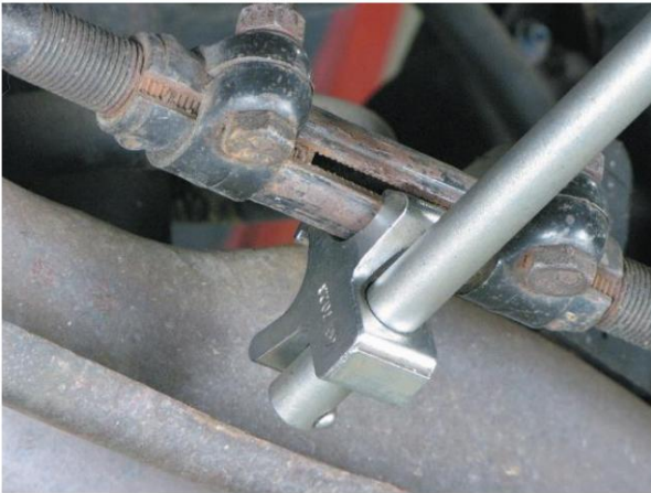
Figura 14. Se utiliza una herramienta especial de ajuste de la barra de acoplamiento para girar los manguitos de ajuste de la barra de acoplamiento.
