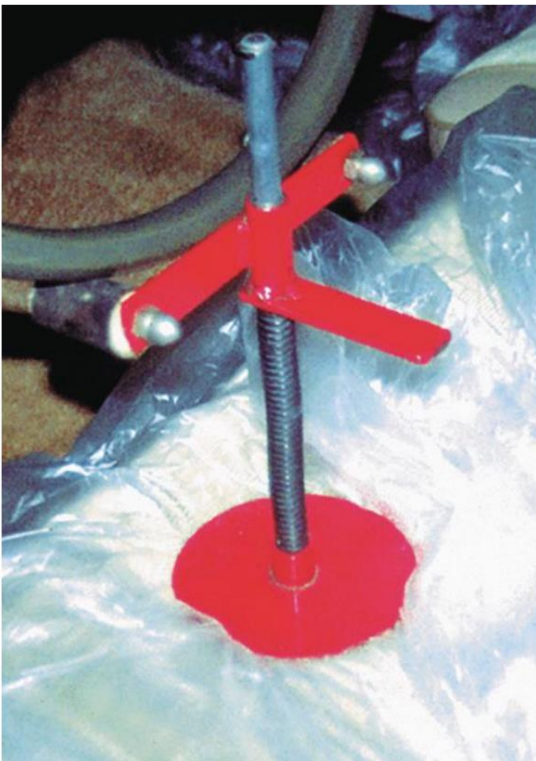
Figura 15. Antes de ajustar la convergencia, el volante se centra y nivela y luego se bloquea en su lugar.
