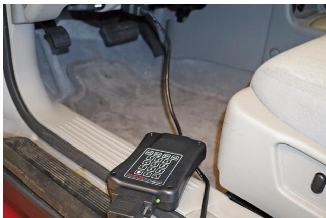
Figura 25. La herramienta de reinicio inalámbrico está conectada al DLC.
