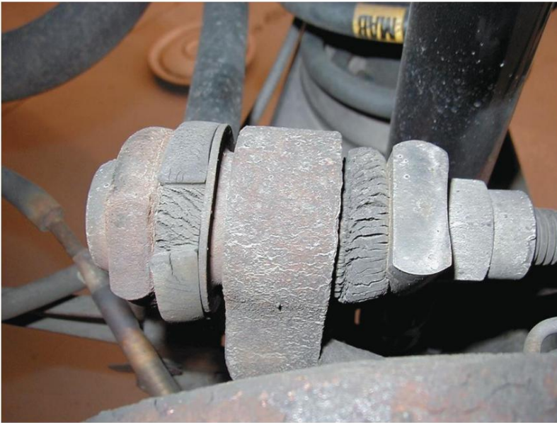
Figura 40 Compruebe los bujes de goma.
