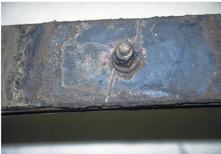
Figura 45. La grieta que se muestra es lo que descubrió un técnico cuando se quitó la ballesta durante el diagnóstico de una suspensión trasera hundida.
