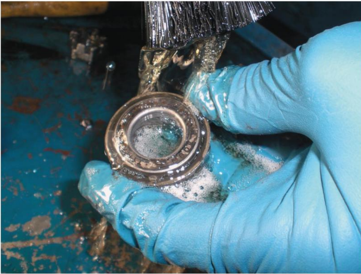
Figura 30. Limpieza del cojinete de la rueda.
