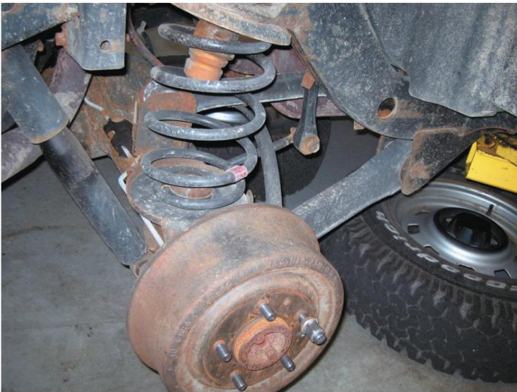
Figura 42. Es necesario desconectar el amortiguador antes de retirar el resorte helicoidal. El proceso de instalación es inverso al de desmontaje.
