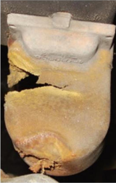
Figura 7. Tope de suspensión dañado por un amortiguador desgastado.
