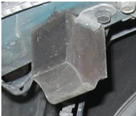
Figura 47. Retire los pernos para reemplazar el tope de choque.
