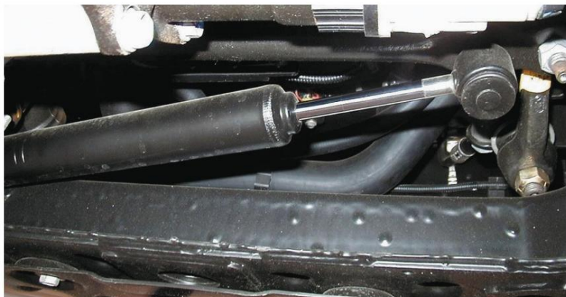
Figura 52. Inspeccione el amortiguador de dirección para detectar fugas y soportes de goma desgastados.
