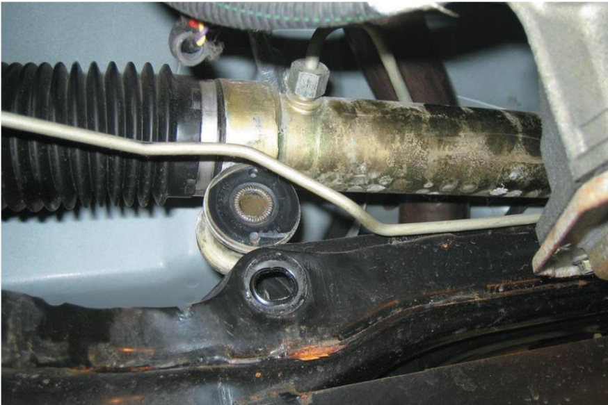
Figura 29. Baje la base del motor y retire los pernos de montaje del bastidor.
