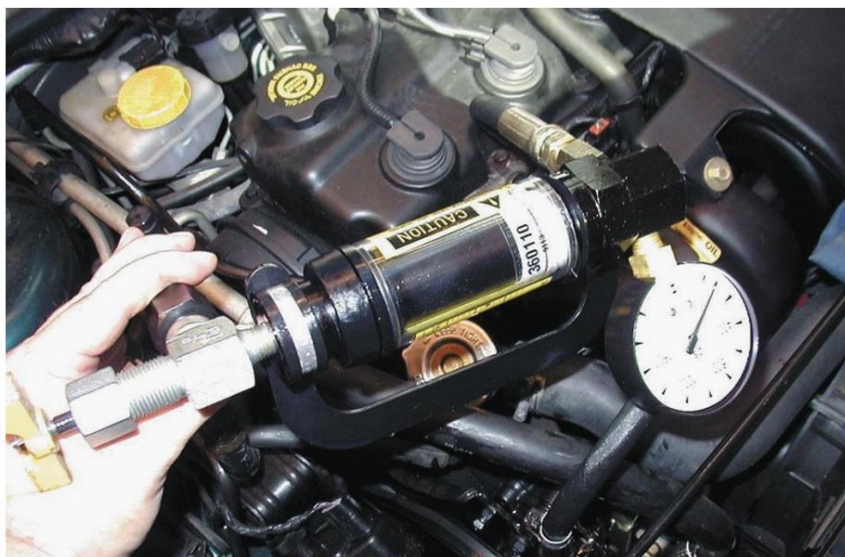
Figura 23. Analizador de dirección asistida que mide tanto la presión como el volumen. La válvula de cierre se utiliza para comprobar la presión máxima de la bomba.
