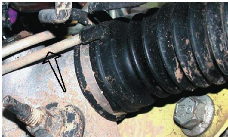
Figura 36. Tubo de purga de aire, generalmente en engranajes de piñón y cremallera asistidos.
