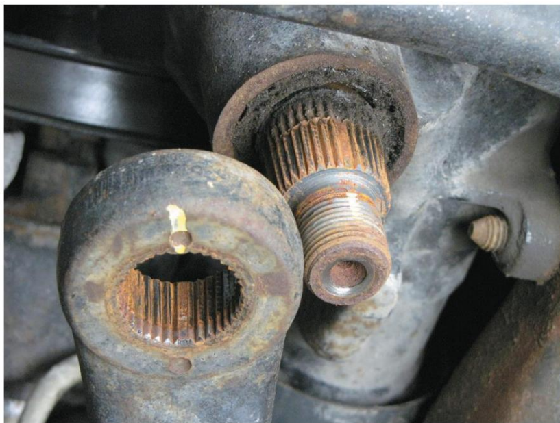
Figura 43. Alinee las estrías de índice anchas al instalar el brazo pitman.
