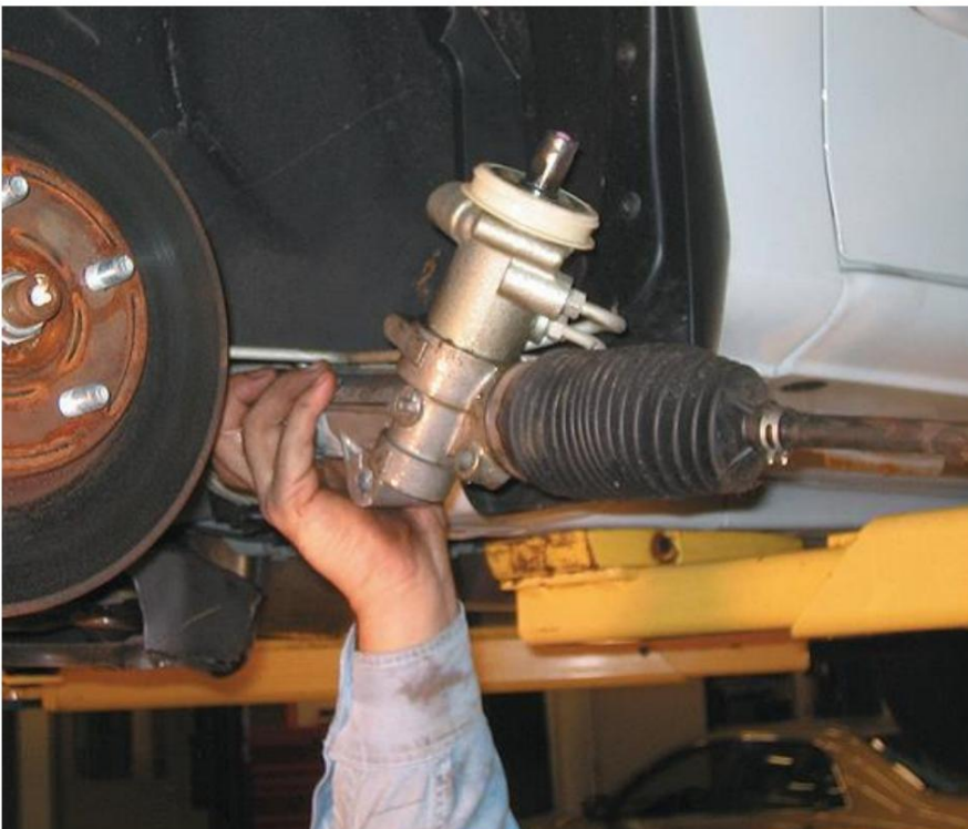
Figura 30. Extracción de la cremallera y el piñón del vehículo.
