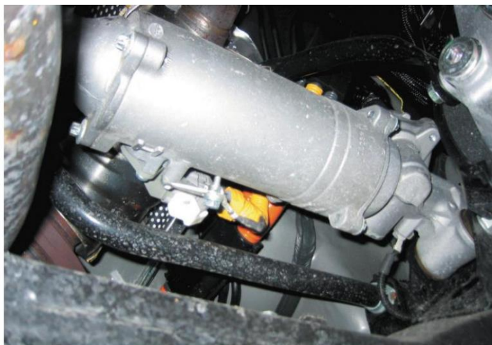
Figura 37. El motor eléctrico rodea el bastidor en este tipo.
