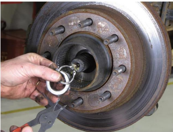
Figura 15. Extracción de la cubierta exterior y el anillo de retención interior y la arandela.
