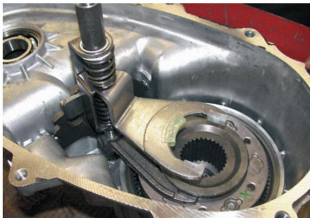
Figura 6. Inspeccione las horquillas de cambio para verificar el desgaste y el movimiento adecuado.
