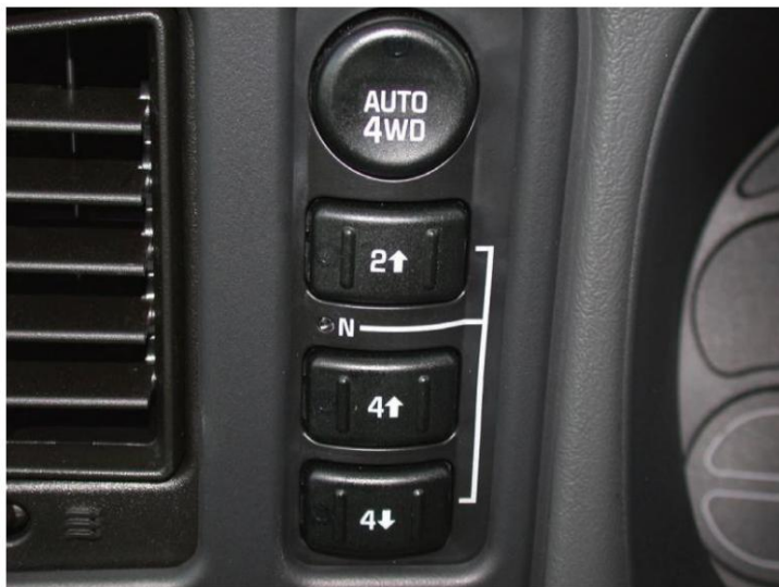
Figura 18. Interruptores electrónicos de selección de rango y modo.
