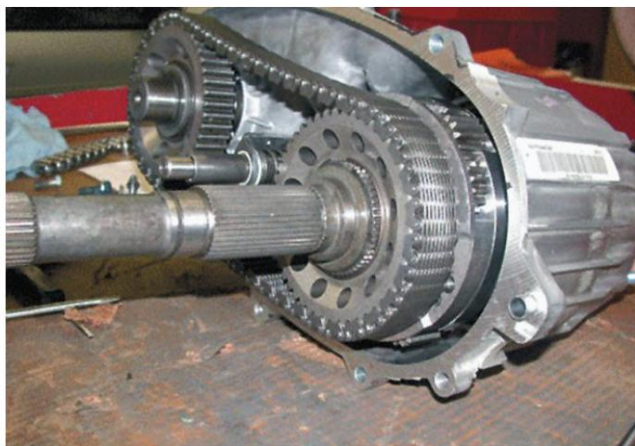
Figura 7. Inspeccione la cadena de transmisión y las ruedas dentadas.
