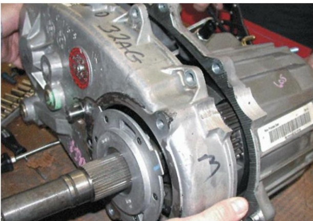
Figura 5. Se están separando las dos mitades de la caja.
