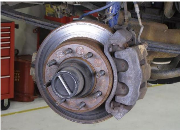
Figura 14. Un cubo de bloqueo operado por vacío.
