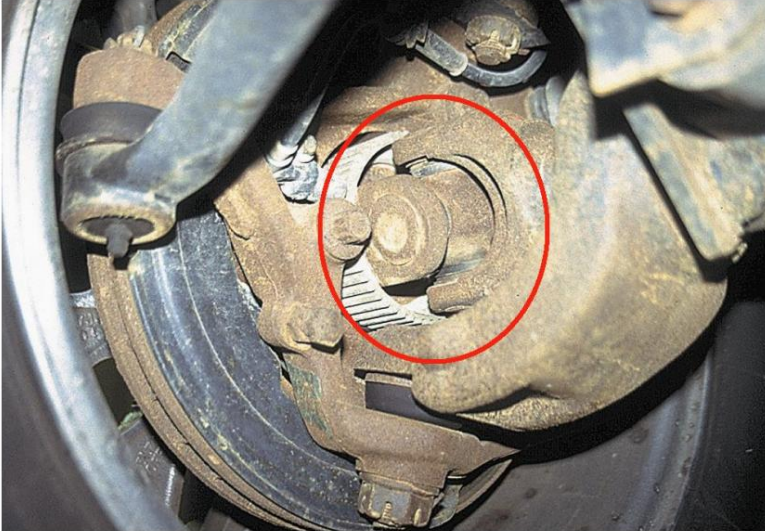
Figura 11. Junta universal en un eje de tracción delantero.
