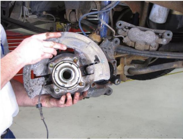
Figura 16. Después de quitar el rotor y las tuercas de fijación, se puede quitar el cojinete de la rueda.
