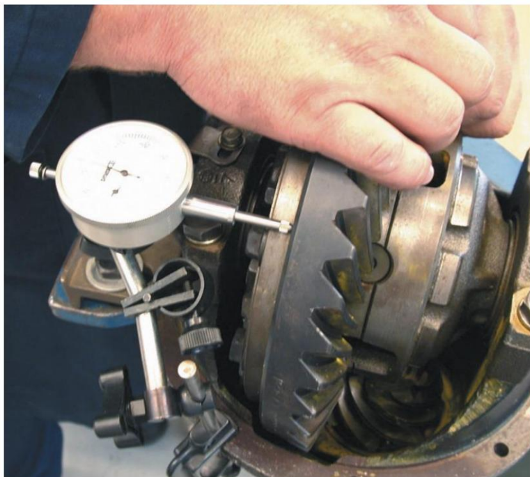
Figura 13. El descentramiento del engranaje anular debe ser inferior a 0,002 pulgadas (0,05 mm), medido con un indicador de cuadrante.
