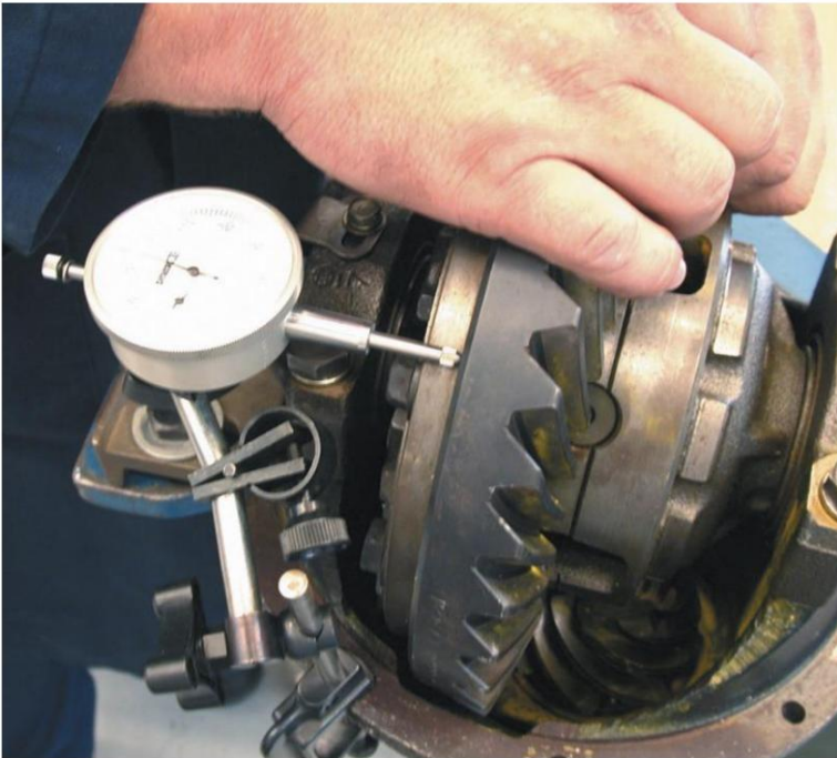
Figura 29. El descentramiento del engranaje anular debe ser inferior a 0,002 pulgadas (0,05 mm), medido con un indicador de cuadrante.
