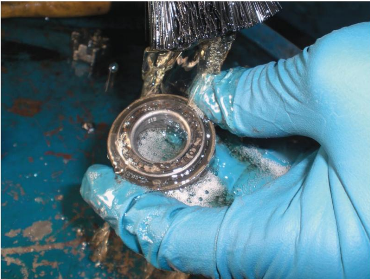
Figura 18. Limpieza del cojinete de la rueda.
