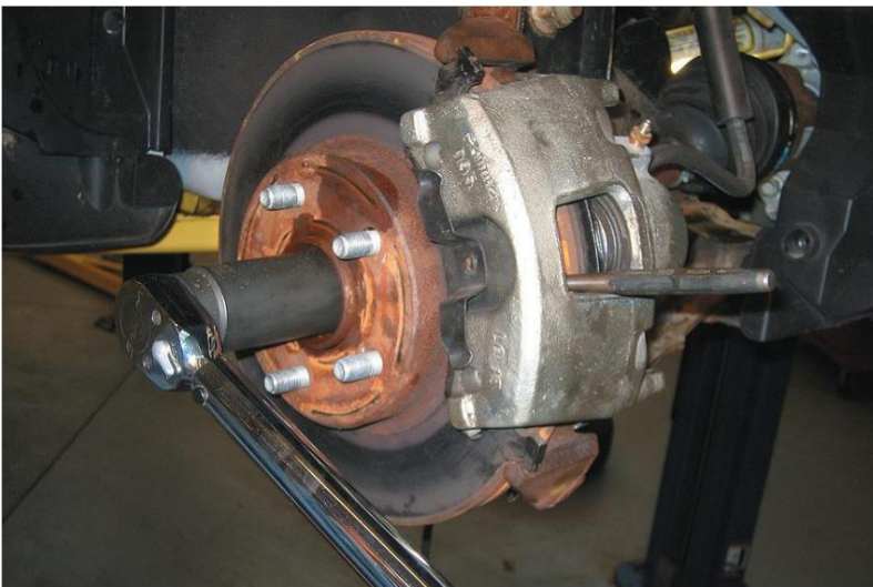
Figura 12. Apriete la tuerca del eje de transmisión con una llave dinamo métrica.
