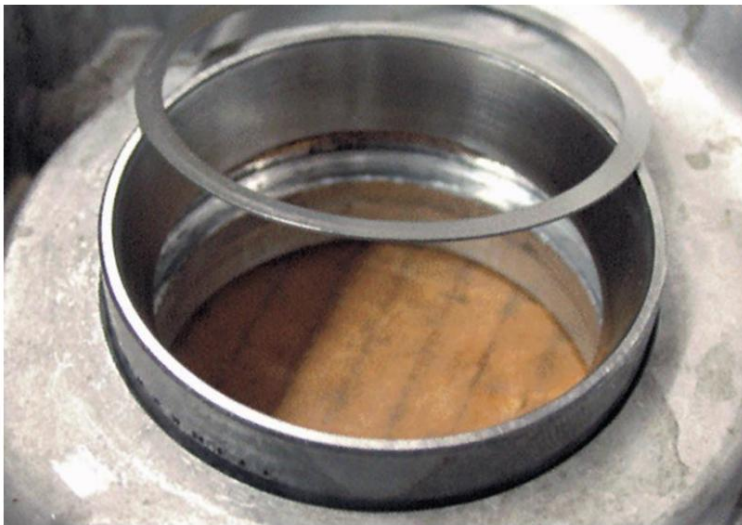
Figura 23. Calce de precarga del cojinete diferencial.
