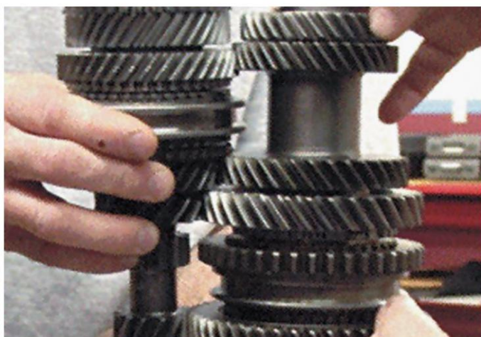
Figura 15. Se verifica que el eje de entrada (izquierda) y el eje de salida (derecha) estén ensamblados correctamente antes de instalarlos en la caja.
