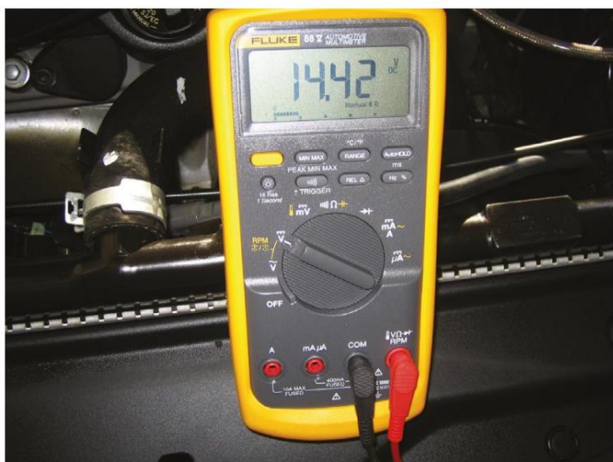
Figura 25. Un voltímetro digital que mide el voltaje de la batería.
