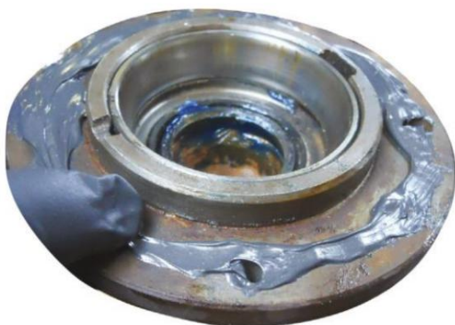
Figura 6. El sellador reemplaza a la junta.
