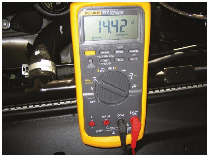
Figura 21. Un voltímetro digital que mide el voltaje de la batería.
