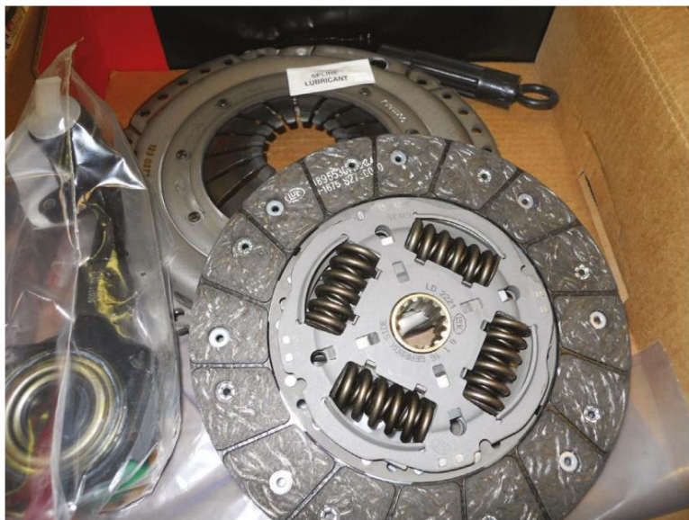
Figura 8. Un kit de embrague típico, que incluye el disco de embrague, la placa de presión y el cojinete de liberación (de desembrague), así como grasa para las estrías y una herramienta de alineación del disco de embrague.
