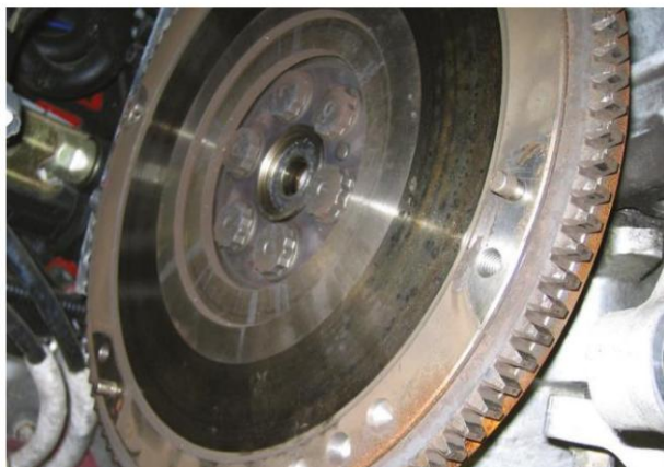
Figura 11. Inspeccione los dientes del engranaje anular.
