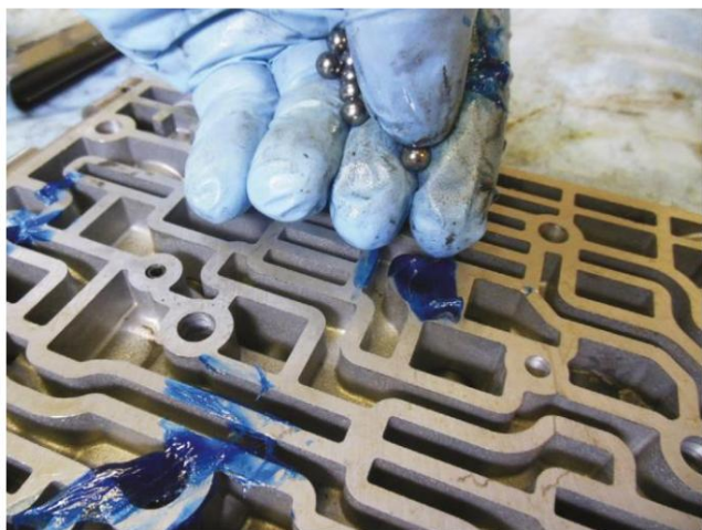
Figura 23. Use lubricante de montaje para mantener las bolas de retención en su posición durante el reensamblaje.
