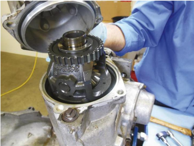
Figura 11. Extracción del conjunto de transmisión final y diferencial de un transeje.
