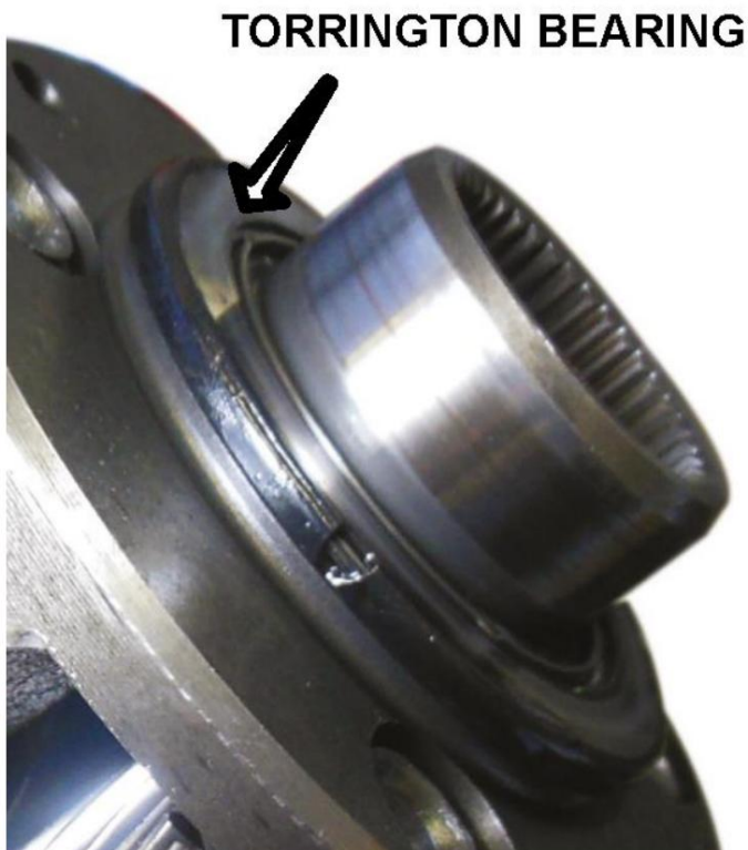
Figura 18. Un cojinete Torrington soporta fuerzas de empuje laterales.
