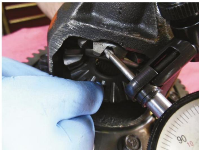
Figura 25. Comprobación del juego libre del engranaje diferencial.
