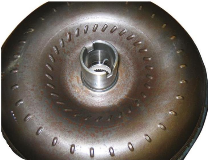
Figura 5. Las muescas en el cubo del convertidor deben estar alineadas con las lengüetas de transmisión de la bomba.
