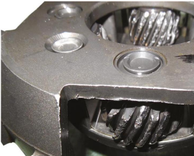
Figura 20. Se reemplazan los juegos de engranajes dañados.
