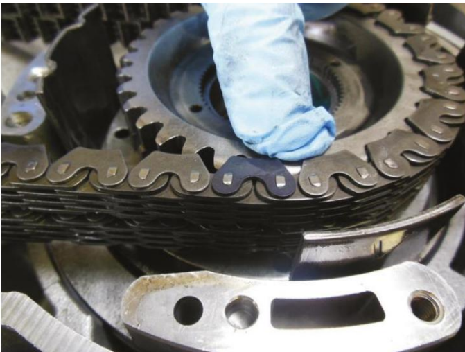
Figura 10. El enlace maestro está orientado hacia ARRIBA y debe reinstalarse de la misma manera.
