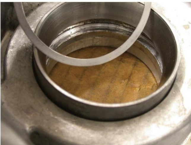
Figura 27. La cuña selectiva se instala detrás de la copa del cojinete para proporcionar la precarga adecuada al cojinete.
