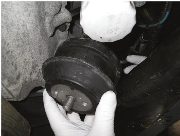
Figura 16. Reemplazo de un soporte del tren de potencia.
