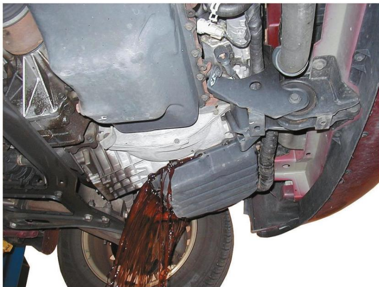
Figura 17. Drenaje del líquido. Algunos vehículos tienen un tapón de drenaje de la transmisión.
