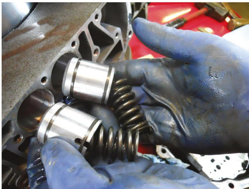
Figura 11. Los acumuladores utilizados en un Chrysler 41TE parecen iguales pero utilizan resortes diferentes.
