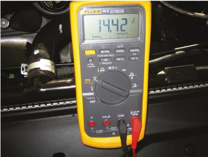
Figura 20. Un voltímetro digital que mide el voltaje de la batería.
