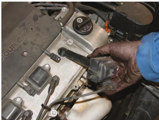
Figura 16. Verifique que la bobina COP no tenga arcos eléctricos ni corrosión.
