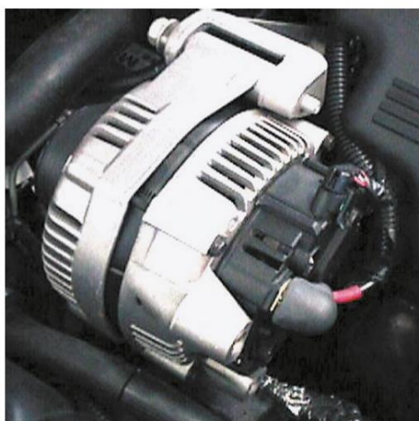
Figura 10. Alternador (también llamado generador).
