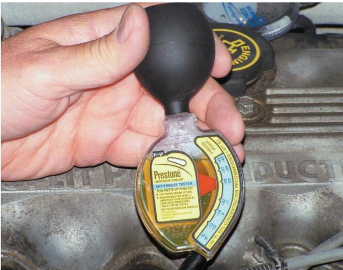
Figura 20. Hidrómetro de refrigerante.
