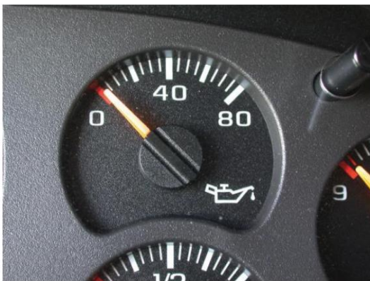
Figura 2. El manómetro de aceite del tablero puede ser un buen indicador de la presión del aceite del motor. Si tiene alguna duda sobre la presión del aceite, utilice siempre un manómetro mecánico para estar seguro.
