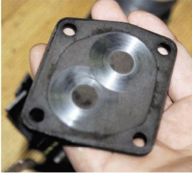
Figura 6. Una placa del extremo de la bomba de aceite desgastada.
