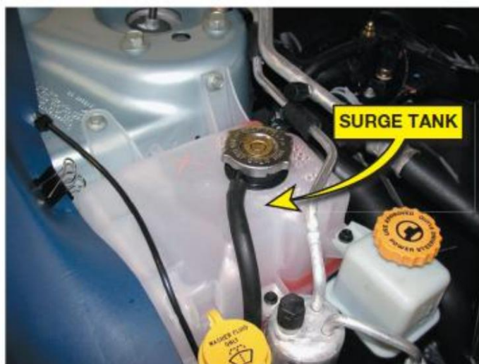
Figura 14. Tanque de compensación y tapa de presión.
