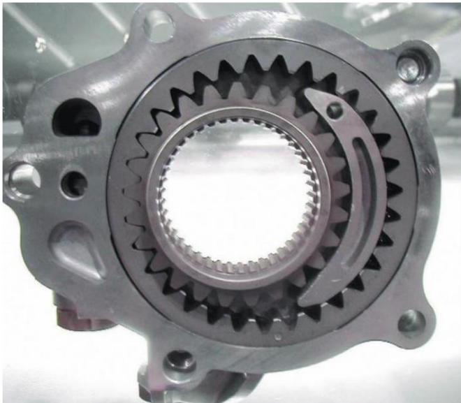
Figura 3. Esta bomba de aceite es impulsada por el cigüeñal y está ubicada en la cubierta delantera del motor.
