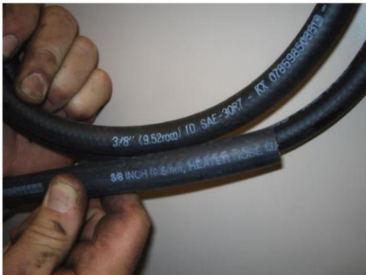
Figura 16. La manguera superior de 3/8 de pulgada está diseñada para aceite y líquidos similares, mientras que la manguera de 3/8 de pulgada que se encuentra debajo está etiquetada como "manguera del calentador" y está diseñada para refrigerante.
