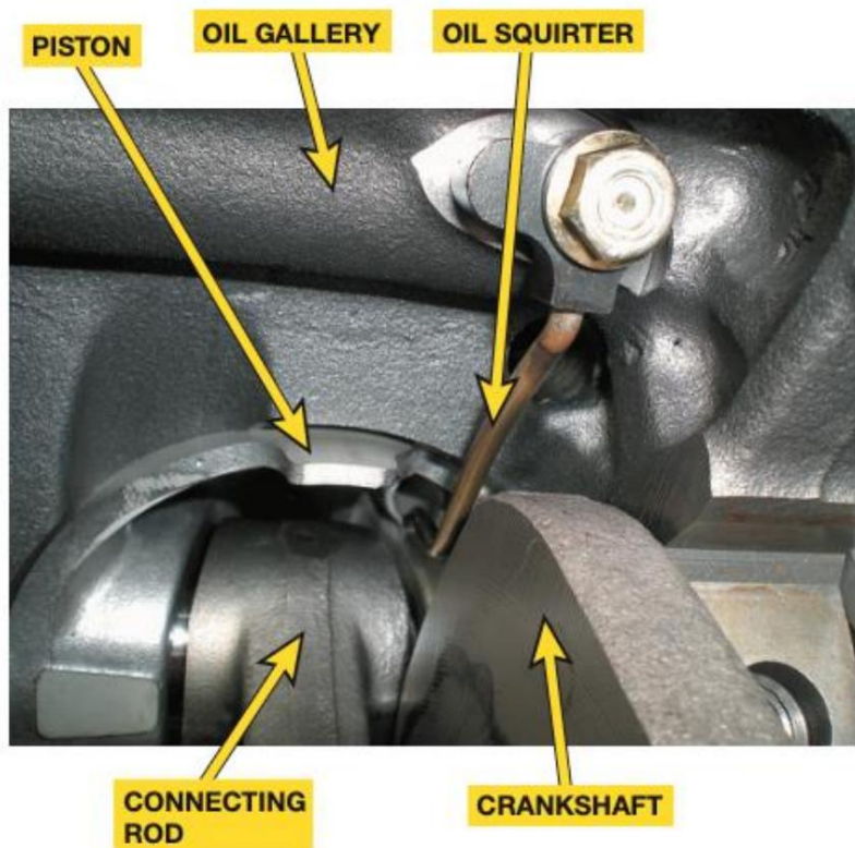
Figura 13. Boquilla de enfriamiento del pistón.
