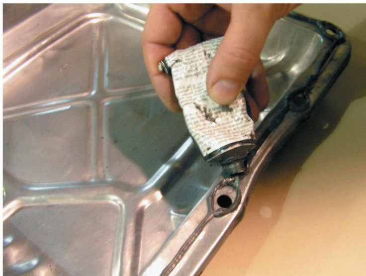
Figura 39. Preparación de la tapa de distribución para la instalación.
