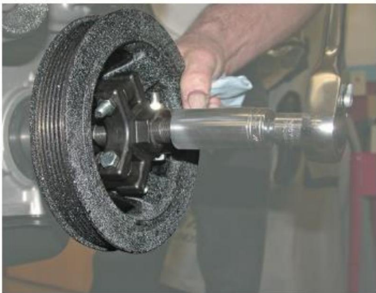
Figura 8. Extracción del amortiguador de vibraciones.
