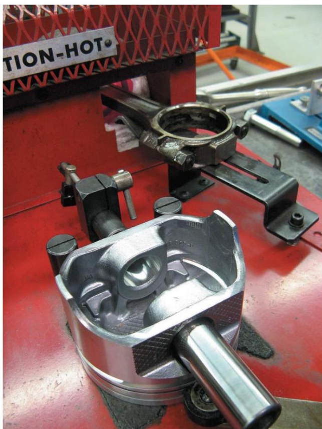
Figura 30. El pasador del pistón se empuja hacia el extremo pequeño calentado de la biela.
