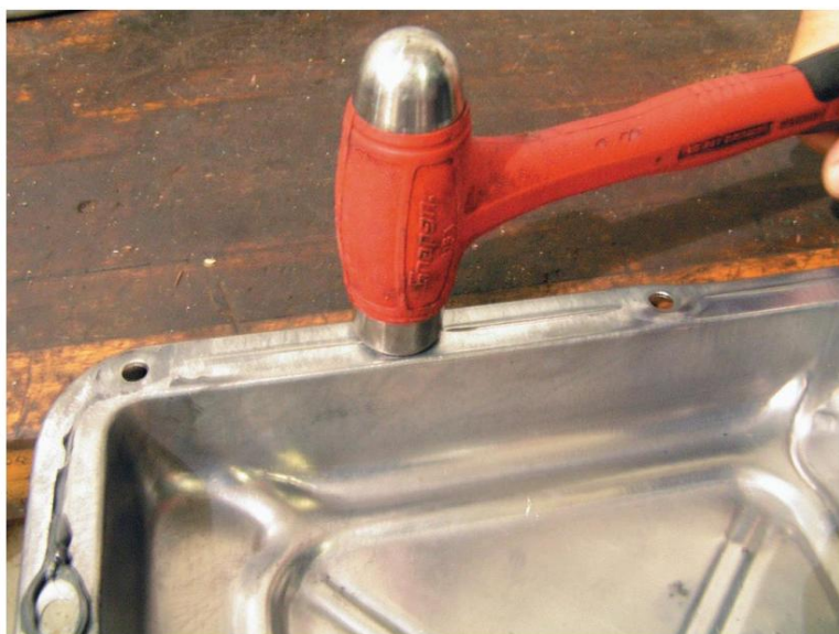
Figura 40. Enderezamiento de un cárter de aceite.
