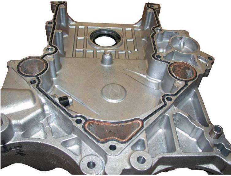
Figura 35. Una cubierta delantera del motor sellada con una junta formada en su lugar.
