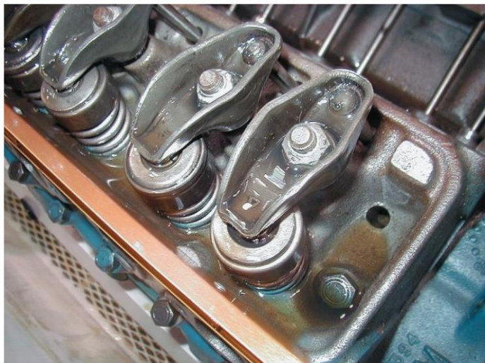
Figura 41. El motor debe estar prelubricado hasta que se vea aceite.
