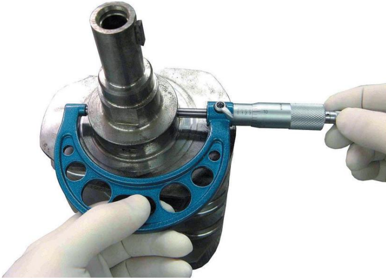
Figura 16. Medición de un muñón principal del cigüeñal.
