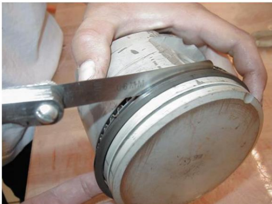
Figura 28. Comprobación del juego lateral del anillo del pistón.
