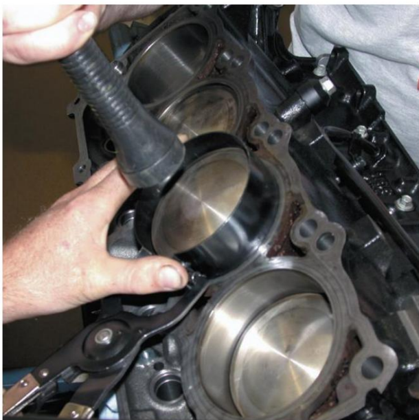
Figura 31. Instalación del pistón.
