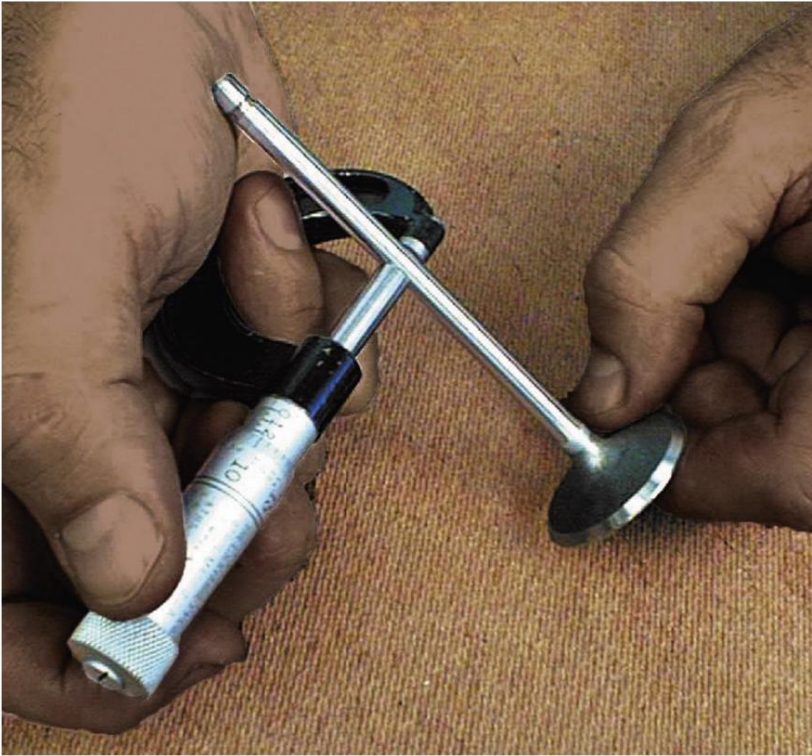
Figura 13. Medición de la guía de la válvula y del vástago de la válvula utilizando un micrómetro.
