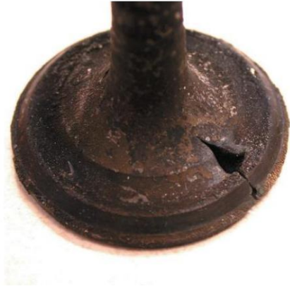
Figura 9. Una válvula dañada por temperatura excesiva en la cámara de combustión.
