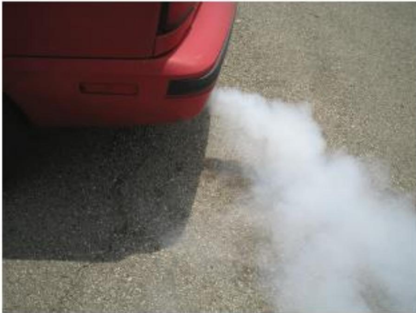
Figura 8. Un exceso de escape blanco indica agua o refrigerante en la cámara de combustión.
